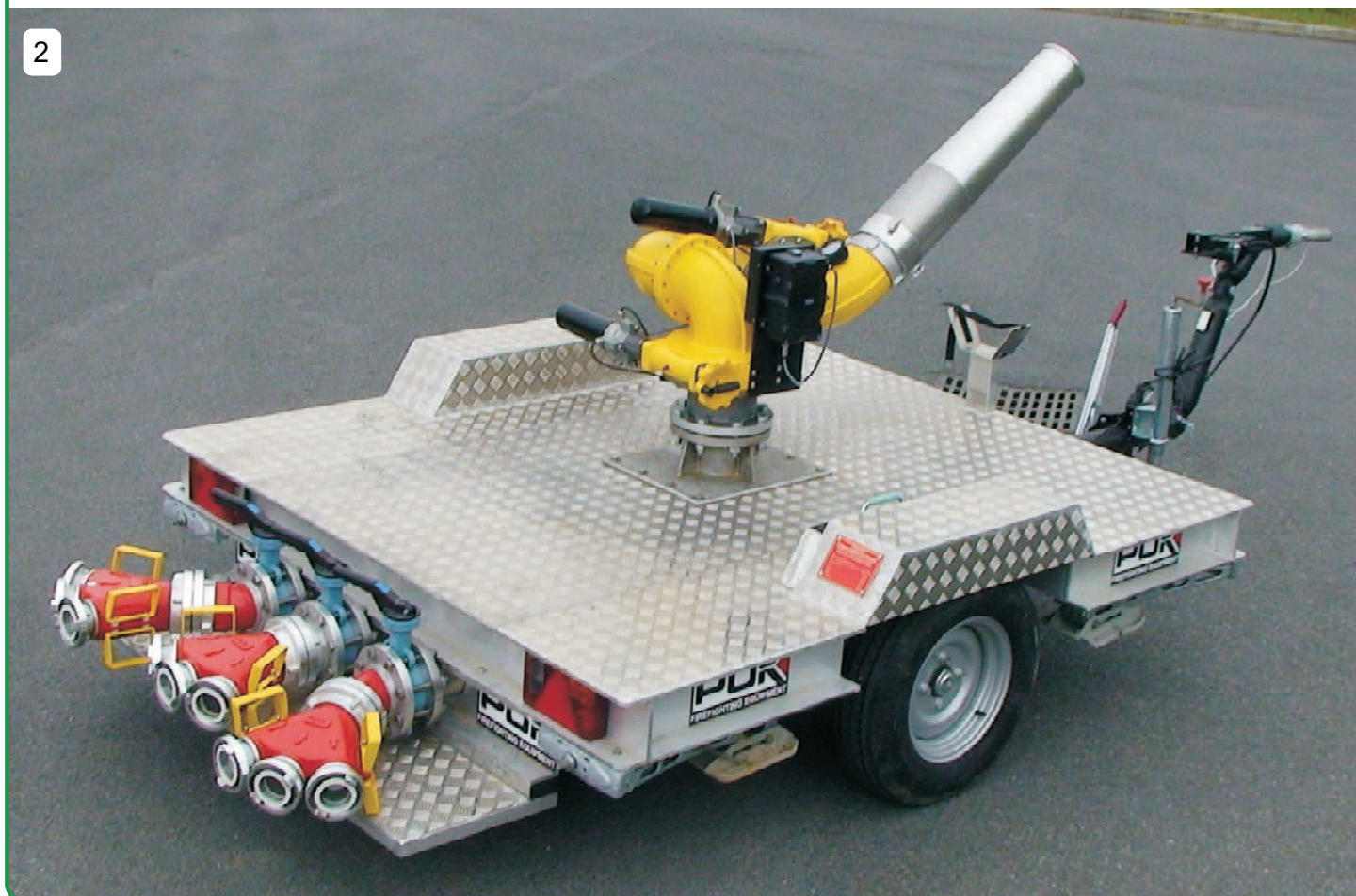
2) Monitor "DICODOPLUS DN 150" radio-comandato con lancia acqua-schiuma "POWER-FOAM" da 9000 l/min su rimorchio.
