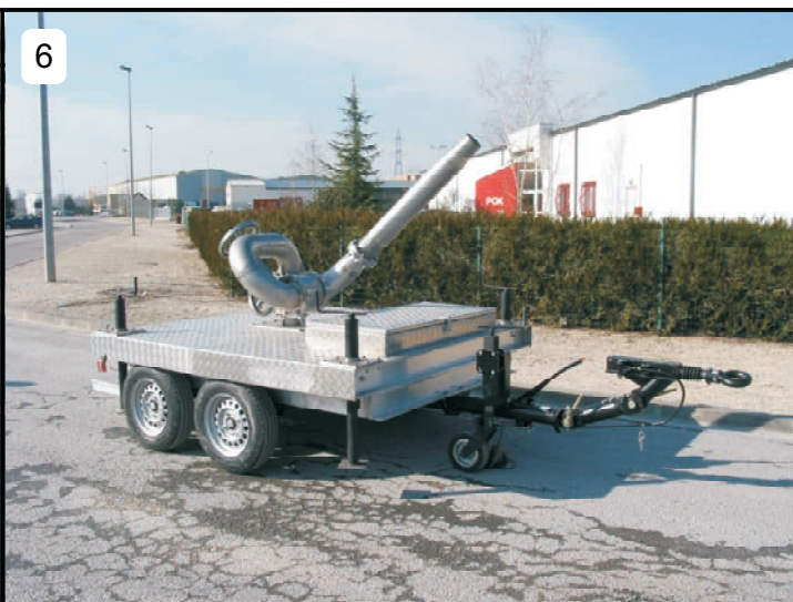
6 - Monitor "GEARATOR 9000" su piattaforma con lancia acqua-schiuma da 9000 l/min.
